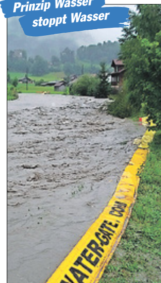
Water-Gate nutzt das Prinzip „Wasser stoppt Wasser“ und besteht aus geschickt angepassten PVC-Planen. Das Wasser fließt hinein und bewirkt, dass sich die Planen als Barriere selbständig entfalten und stabilisieren. Die Schutzhöhe beträgt bis zu 2m. Eine Rolle ist 15m lang und kann sofort tausende von Sandsäcken ersetzen. Die Barriere muss weder befestigt noch gefüllt, sondern einfach nur entrollt werden.
