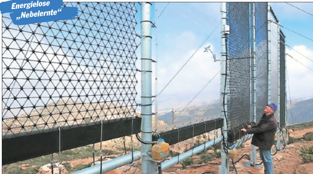
Mit dem CloudFisher hat die WasserStiftung einen Nebelkollector entwickelt, der ohne Energie Trinkwasser aus Nebel gewinnt. Er ist in allen trockenen Gebirgs- und Küstenregionen einsetzbar, in denen längere Nebelperioden auftreten. Die tägliche Wasserausbeute eines Moduls mit 9m 2 Netzfläche liegt zwischen 36 und 126 Litern. In Marokko wurden Spitzenwerte von über 600 Liter pro Tag erzielt. Der weltweit erste serienmäßige „Nebelernter“ hält Windgeschwindigkeiten von bis zu 120 km/h stand. Alle Materialien sind lebensmittelecht. Mit dem gewonnenen Wasser können hunderttausende Menschen mit Trinkwasser versorgt werden. Fotos (5): Wasser Berlin
