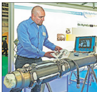
Der Clou der Firma IBG Hydro Tech: Bei der Hausanschlusssanierung vom Hauptkanal aus muss das Privatgrundstück nicht betreten werden. Foto: SPREE-PR/Petsch
